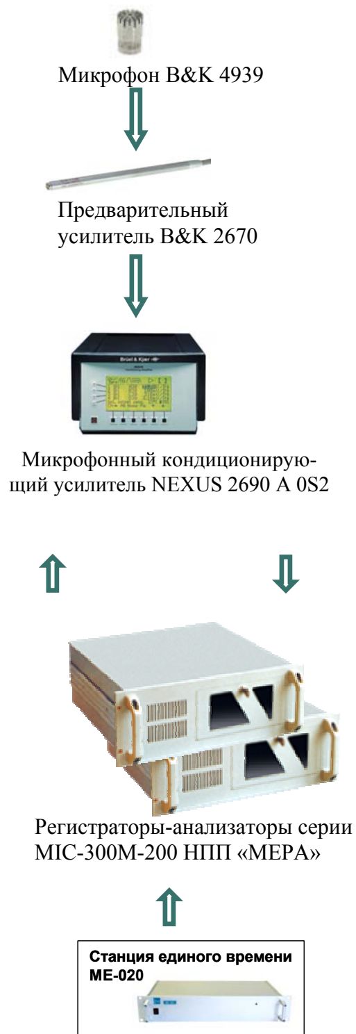
Рис. 3 – Схема прохождения информационных сигналов при акустических испытаниях
