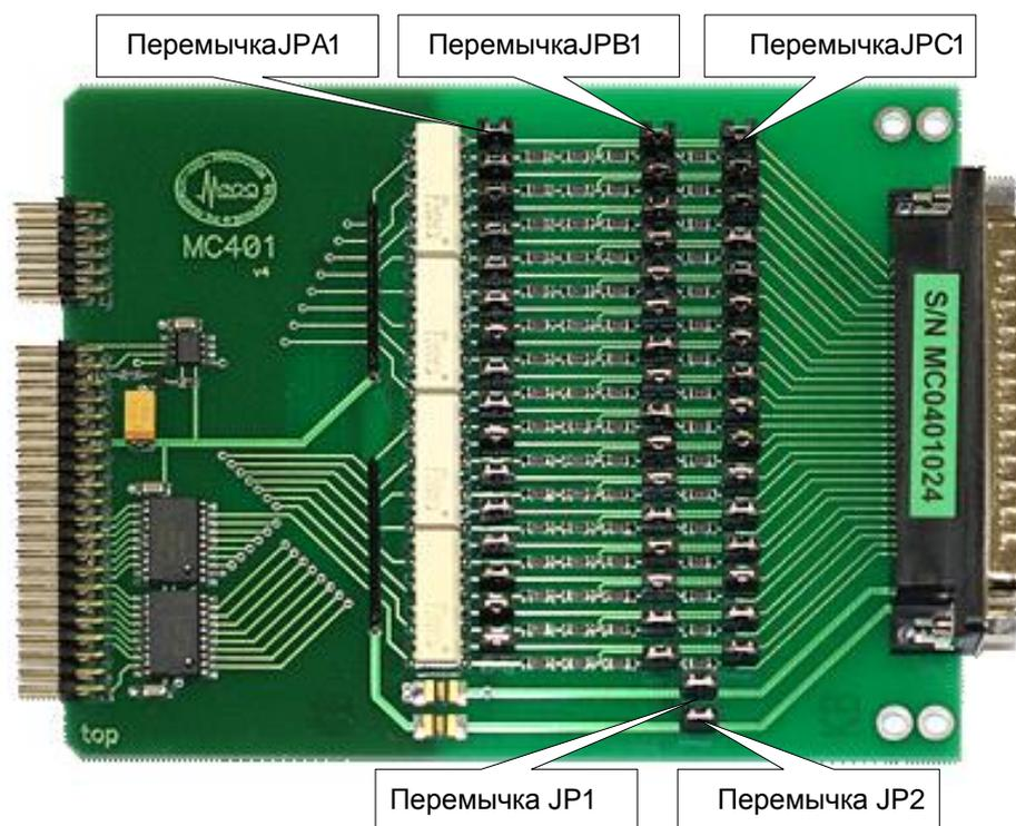
Рисунок 2- Плата модуля MC401
